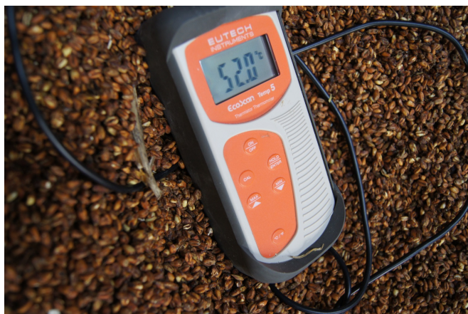
Et spydtermometer er et vigtigt instrument til akut fejlsøgning ved mistanke om belastning af malkekøer forårsaget af problemer med foderhygiejne. Eksemplet viser ludkorn der genopvarmer ved fordærvelsesprocesser.
